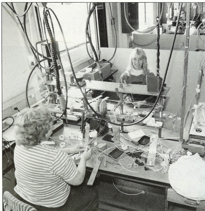
Montricerne Ida Bruun - til venstre - og Jette Holk er her i gang med at montere ledninger og fatninger som en del af forarbejdet til »Københavnerpotten«, der fremstilles på Armaturnonteringen.
