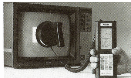
Farveanalytatoren PM 5639 fra Philips TV Test Equipment i funktion. Produktet er udviklet og bliver produceret på fabrikken i Brøndby.
