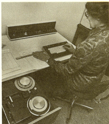
Fru Karen Else Olsen ved magnetbåndindkoderen i Repax. Ved hjælp af skrivemaskinetastaturet indkodes oplysningerne på magnetbåndet, der ligger på båndoptageren i skuffen.
