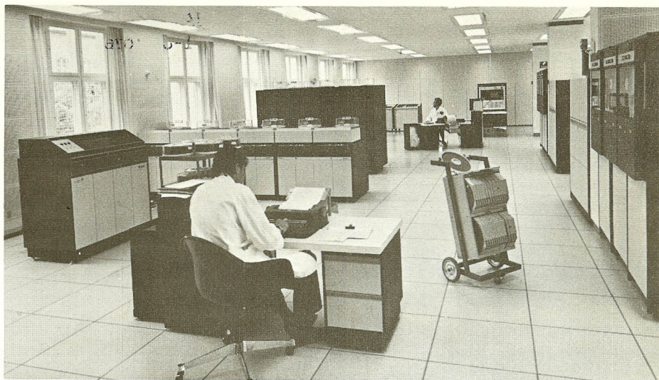
Datacentret på Industrigården med de to store Philips datamaskiner P 1200.
