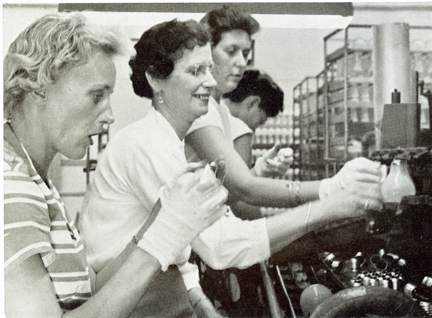
Gudrun Hansen (i midten) ved den maskine, der brænder soklerne fast.
