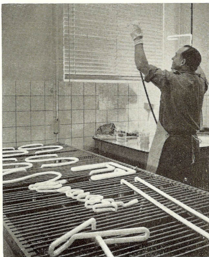
Specialarbejder Hans Nielsen foretager „coatingen“, d. v. s. at en vædske med opslemmet lyspulver hældes i røret og fordeles jævnt på indersiden
