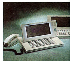
To omstillingsborde med indbygget talevejledning for blindebetjening
