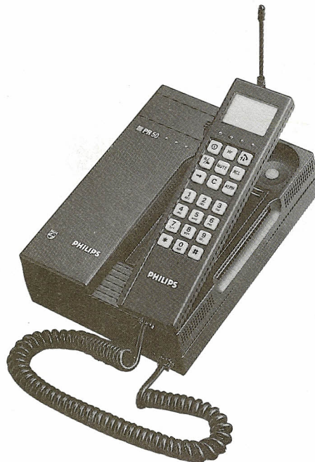
Mobiltelefonen PRV 50 med handsettastatur til brug i NMT-området.
